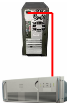
Gambar.1. Konfigurasi instalasi UPS secara stand alone
